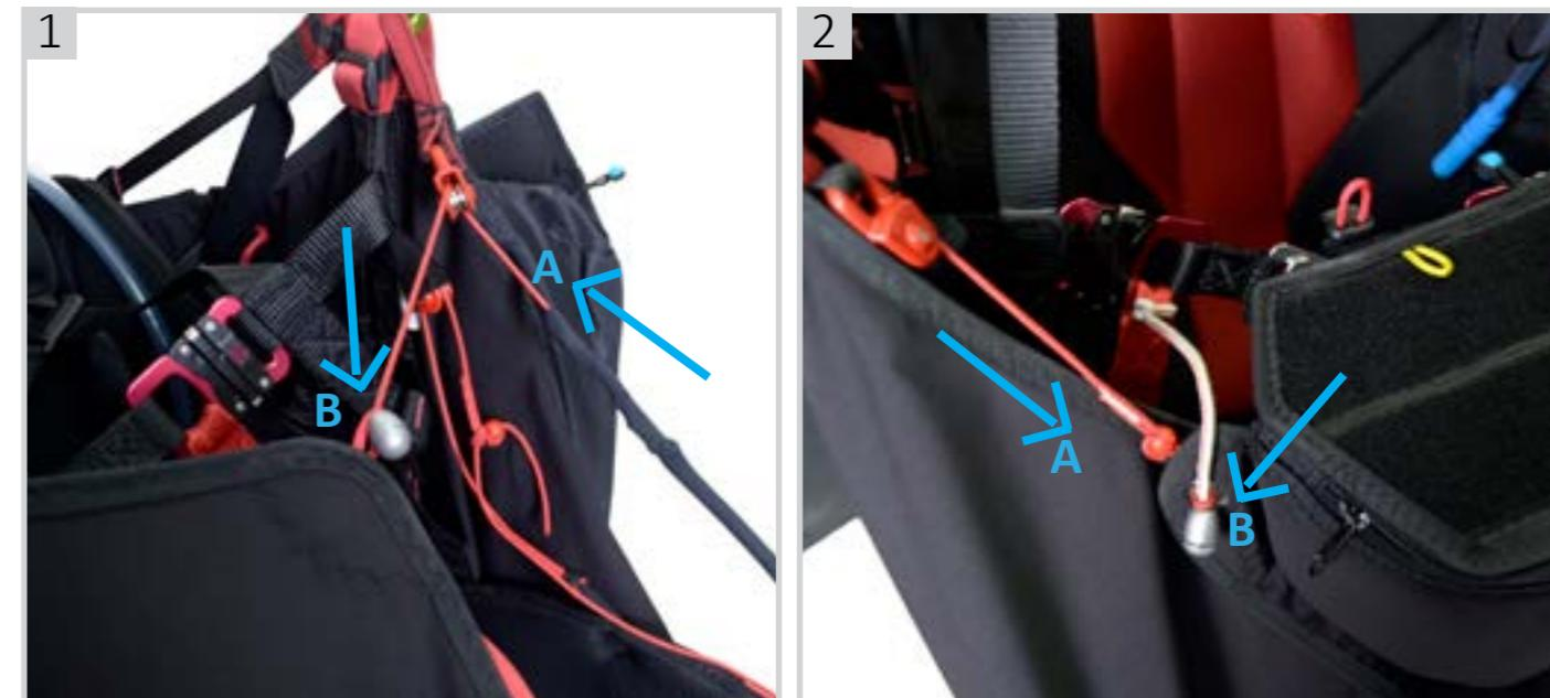
1. fecha a parte inferior da carenagem e facilita a corrida e entrada na carenagem no momento da decolagem.
