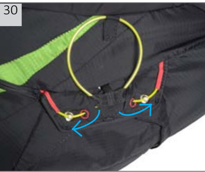
As Seletes SOL possuem um sistema de instalação do paraquedas reserva que facilita o acesso no momento de sacar e lançar, por contar com um acionador que possui uma conexão mais curta.
