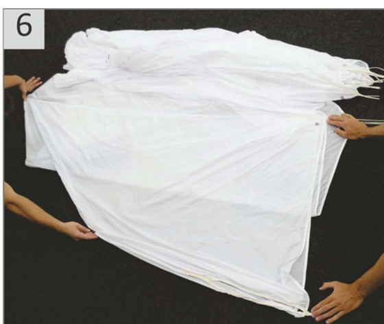
6 Abrir bem o segundo painel para fazer a dobração correta.
