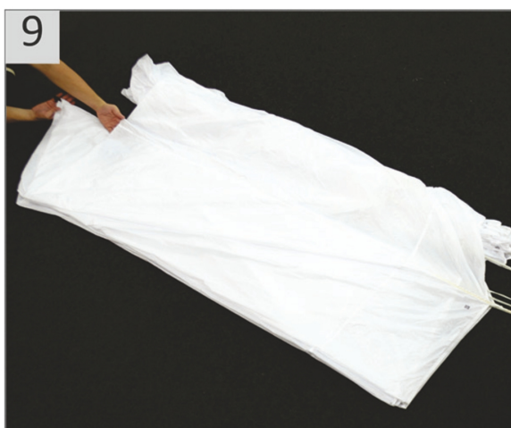
9 Continuar os próximos painéis esticando o tecido com as alças de dobragem.
