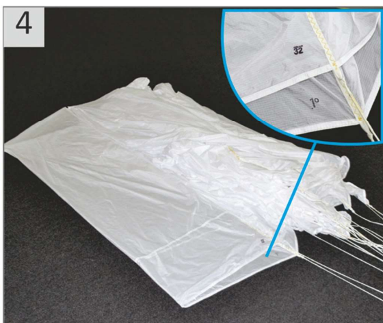
4 Iniciar a dobração pelo primeiro painel conforme indicado na imagem.
