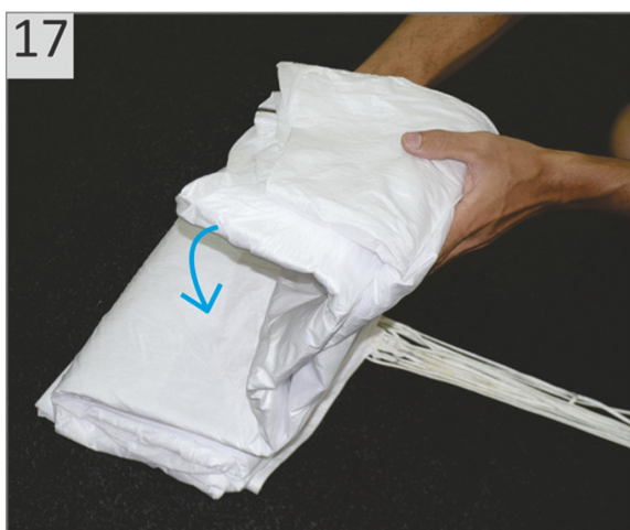
17 Ao final das "sanfonas" dobrar a parte superior para dentro.
