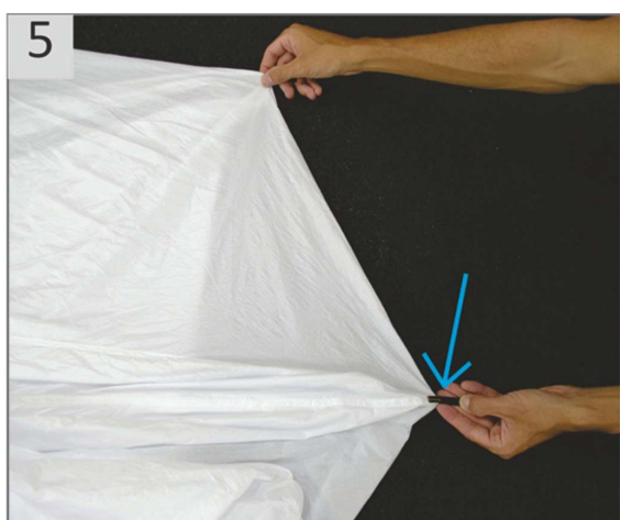
5 Na parte superior esticar o tecido utilizando as alças de dobração, no centro do painel.
