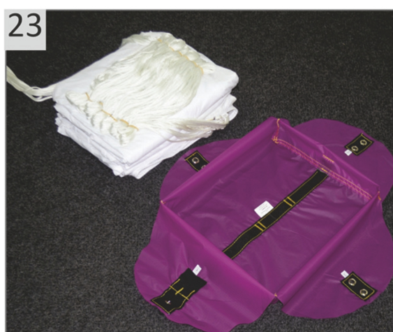
23 Preparar o container de dobragem para colocar o reserva dentro.
