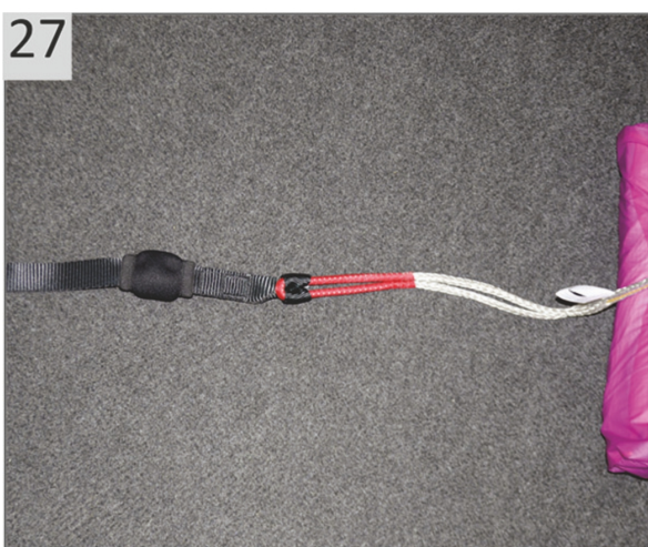
27 Conexão direta com o bridle.
