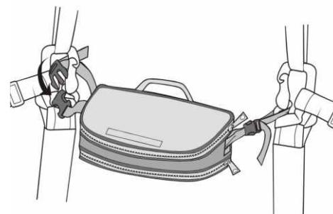
Die **SOL**-Gurtzeuge erlauben es einen Front-Container anzuschließen, in dem der Pilot seine elektronischen Fluginstrumente mitführen kann.
