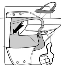
Der Container für den Rettungsschirm wurde so entworfen, dass die meisten der handelsüblichen Rettungsschirme eingebaut werden können. Dennoch sollten Sie nach dem Einbau die Auslösung simulieren und testen, um nicht eine böse Überraschung zu erleben, wenn sie ihn auslösen müssen. Alle Zweifel über die Funktionsweise müssen während des Einbaus und der Einstellung des Gurtzeuges vor dem ersten Flug beseitigt werden.
