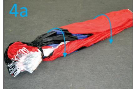
Passo 5. Abra sua capa de dobragem Origami e localize a área amolfadada, coloque a parte das talas do parapente sobre ela, após fechado sobre a parte das talas de maneira que fique ao meio criando mais uma proteção para as talas.
