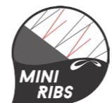
**Mini Ribs:** Perfis entre células no bordo de fuga que melhoram a performance e a pilotagem.
