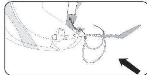
A instalação incorreta do acelerador ou apoio de pé poderá impedir o acionamento e abertura do paráquedas reserva, certifique-se de que isso não ocorra.
