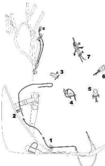
As polias necessárias para se ajustar o Sistema Acelerador se encontram no próprio corpo da selete. Os cabos devem ser passados inicialmente através das roldanas na frente do assento.
