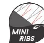
**Mini Ribs:** Perfis entre células no bordo de fuga que melhoram a performance e a pilotagem.
