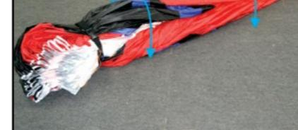
Passo 5. Abra sua capa de dobragem Origami e localize a área amolfadada, coloque a parte das talas do parapente sobre ela, após fechado dobre a parte das talas de maneira que fique ao meio criando mais uma proteção para as talas.
