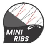
**Mini Ribs:** Perfiles entre as células do bordo de fogo, melhorando performance e pilotagem.
