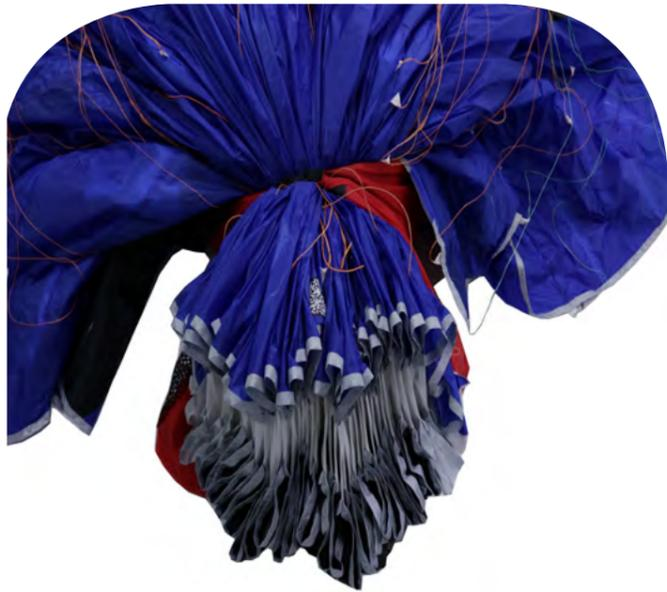
Passo 3. Pelo centro do velame no bordo de ataque, coloque perfil por perfil um em cima do outro, um lado de cada vez. Ajeitando as talas do extradorso e do intradorso deixando-as abertas, dobre o tecido das bocas para o lado de fora do velame.
