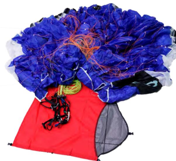
Passo 1. Abra sua capa de dobragem e coloque o parapente repolhado dentro, começando dessa forma se evita que o tecido seja arrastado pelo solo ao dobrar.
