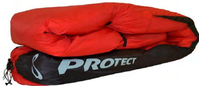
Passo 5. Dobre sua capa de dobragem no mesmo formato da imagem, essa forma evita que tenha menos deformação nas partes rígidas do parapente.
