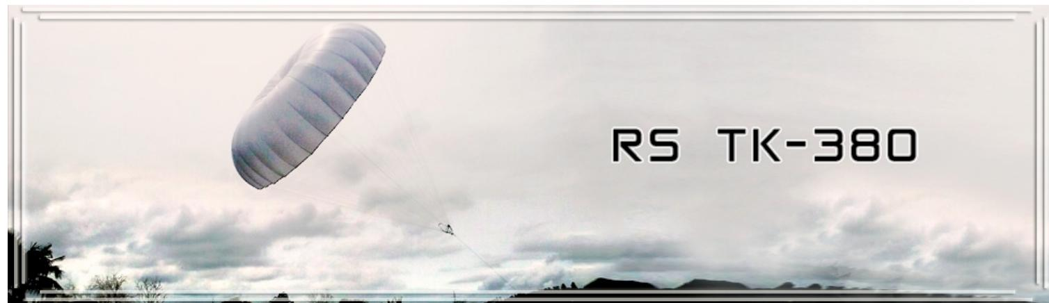
O sistema de emergência TK-380 é um paraquedas de arremesso manual, construído especificamente para uso no voo de paramotor modelo trike. Sua concepção resulta em um tempo de abertura significativamente rápida e sua construção (com contêineres interno e externo) diminui as chances de aberturas involuntárias. Os materiais utilizados em sua fabricação são selecionados com muito cuidado, escolhidos entre os melhores produtos disponíveis no mercado.
