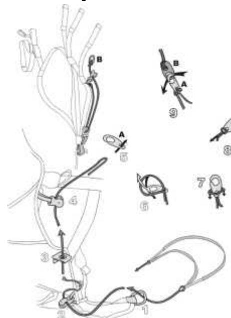
As polias necessárias para se ajustar o Sistema Acelerador se encontram no próprio corpo da selete. Os cabos devem ser passados inicialmente através das roldanas na frente do assento.
