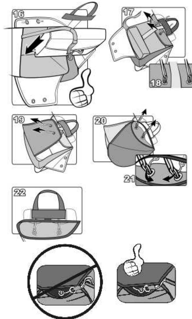
As Seletes **SOL** possuem um sistema de instalação do pára-quedas reserva que facilita o acesso no momento de sacar e lançar, por contar com um acionador que possui uma conexão mais curta.
