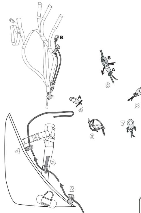
As polias necessárias para se ajustar o Sistema Acelerador se encontram no próprio corpo da selete. Os cabos devem ser passados inicialmente através das roldanas na frente do assento.
