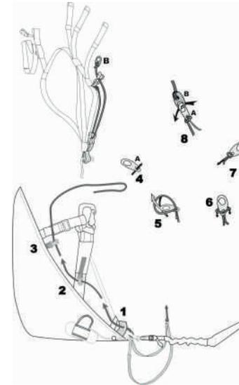
As polias necessárias para se ajustar o Sistema Acelerador se encontram no próprio corpo da selete. Os cabos devem ser passados inicialmente através das roldanas na frente do assento.
