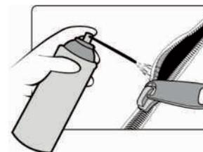
O zíper deve abrir e fechar macio com o cursor deslizando suavemente. Se houver dificuldade em movimentar o cursor deve ser aplicado parafina ou "spray" lubrificante nos dentes, para diminuir o atrito entre os componentes. Com alguma movimentação do zíper, você vai notar a diferença.
