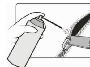
O zíper deve abrir e fechar macio com o cursor deslizando suavemente. Se houver dificuldade em movimentar o cursor deve ser aplicado parafina ou "spray" lubrificante nos dentes, para diminuir o atrito entre os componentes. Com alguma movimentação do zípper, você vai notar a diferença.
