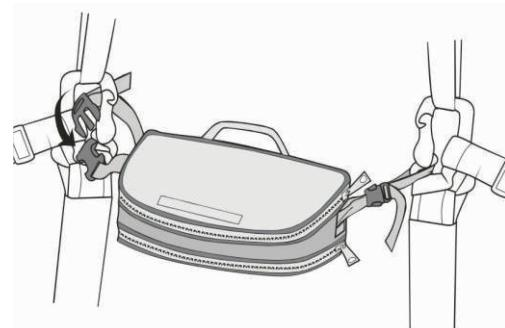
A linha de Seletes **SOL** permite a acoplagem de um recipiente especial (container), onde o piloto pode colocar seus instrumentos eletrônicos durante o voo.
