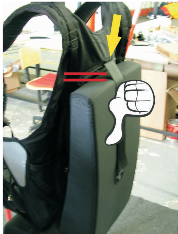
Figura 2: Protetor fixado erroneamente. Velcro está mais alto que o protetor. Em um impacto o protetor pode subir. Recomenda-se instalar o Kit velcro.
