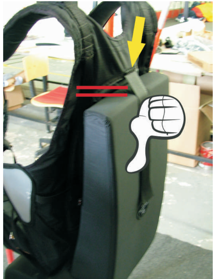
Abbildung 2: Fehlerhafte Fixierung des Protectors. Das Klettband der Fixierung ist so angebracht, dass der Protektor, bei Belastung, nach oben geschoben werden kann.
