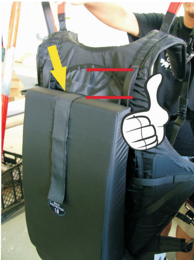
Abbildung 1: Korrekte Fixierung des Protectors. Das Klettband der Fixierung ist so angebracht, dass der Protektor sicher in seiner Position gehalten wird.
